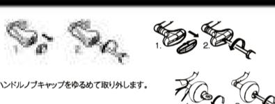
1. ノブの根元を手で押さえながら、コインでハンドルノブキャップをゆるめて取り外します。
